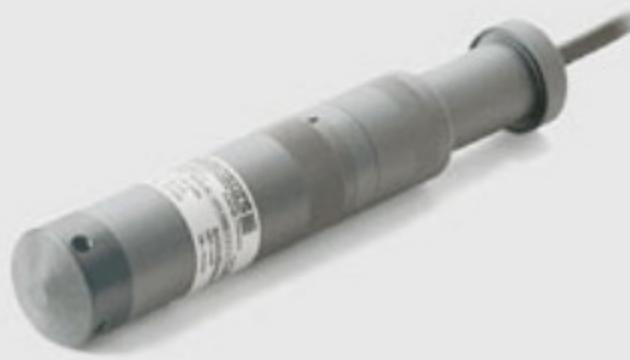
Погружной зонд LMP 808 (ЛМП 808) предназначен для непрерывного измерения уровня жидкостей, не агрессивных к материалу корпуса PVC (поливинилхлорид) и нержавеющей стали. Благодаря открытой мемbrane датчик может применяться для измерения уровня вязких субстанций. Для этого снимается защитная крышка. Для удобства обслуживания соединение зонда с кабелем выполнено разъёмным, что позволяет при необходимости без дополнительных затрат времени легко произвести замену.
